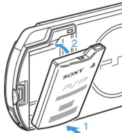
Выверните зажимы крышки батарейного отсека с системой и защелкните крышку.
