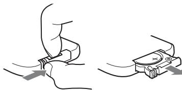
**2 Sostituire la batteria CR2025 con una nuova, con il lato + rivolto verso l'alto.**
