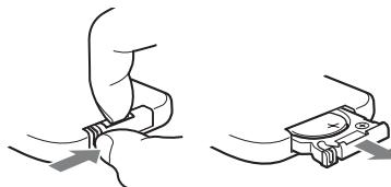
**2** Vervang de CR2025-batterij door een nieuwe batterij, met de pluspool (+) naar boven gericht.
