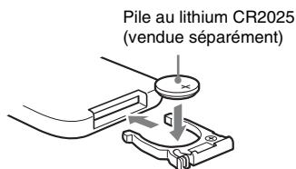
**3** Appuyez sur le logement de la pile jusqu'au déclic pour le remettre en place.
