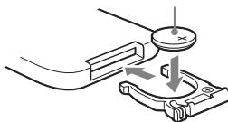
**3 Empuje de nuevo el compartimento de la pila hacia la posición inicial hasta que oiga un clic.**
