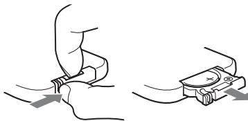
**2** Substitua a pilha CR2025 por uma nova, com o lado + virado para cima.
