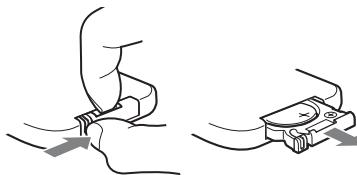
**2 Sustituya la pila CR2025 por otra nueva, con la cara + orientada hacia arriba.**
